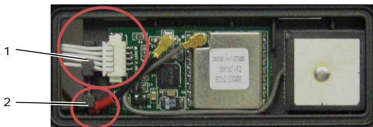
1 USB-kabelkanal 2 GPS gennemgangskabelkanal
